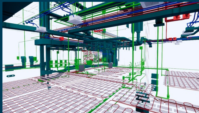
BIM MODEL TECHNICKÝCH ZARIADENÍ BUDOV
